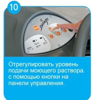
10 Отрегулировать уровень подачи моющего раствора с помощью кнопки на панели управления.
