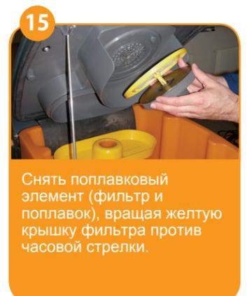
15 Снять поплавковый элемент (фильтр и поплавок), вращая желтую крышку фильтра против часовой стрелки.
