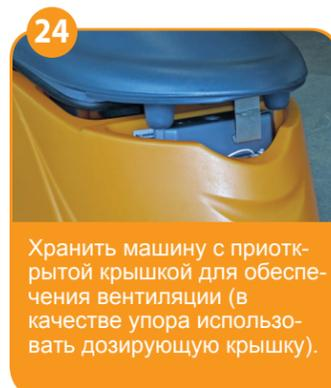
24 Хранить машину с приоткрытой крышкой для обеспечения вентиляции (в качестве упора использовать дозирующую крышку).
