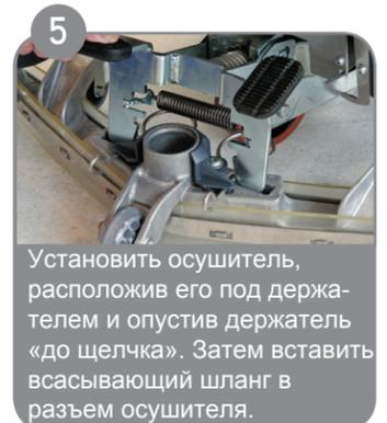
5 Установить осушитель, расположив его под держателем и опустив держатель «до щелчка». Затем вставить всасывающий шланг в разъем осушителя.
