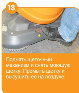
18 Поднять щеточный механизм и снять моющую щетку. Промыть щетку и высушить ее на воздухе.
