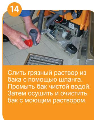
14 Слить грязный раствор из бака с помощью шланга. Промыть бак чистой водой. Затем осушить и очистить бак с моющим раствором.
