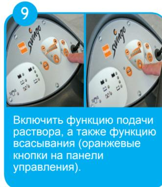
9 Включить функцию подачи раствора, а также функцию всасывания (оранжевые кнопки на панели управления).
