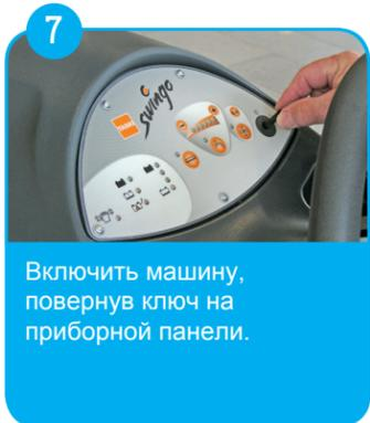
7 Включить машину, повернув ключ на приборной панели.
