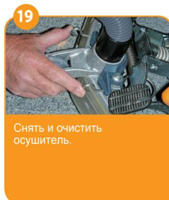
19 Снять и очистить осушитель.
